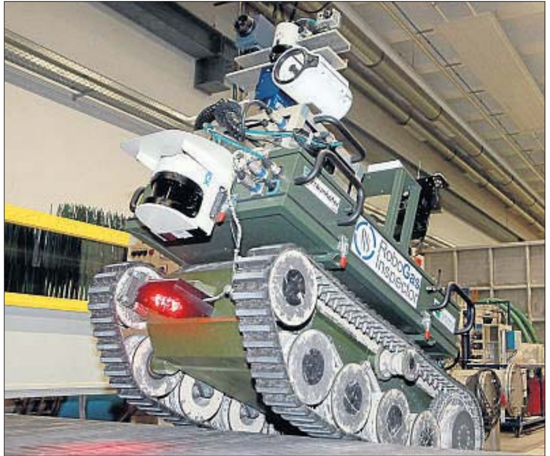
Wie aus einem Science-Fiction-Film: Der Prototyp des RoboGasInspector fährt selbstständig einen vorgegebenen Inspektionsparcours ab und sucht mit seinen Instrumenten nach Gaslecks. Fotos: Herzog
